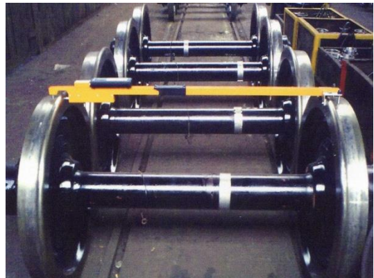
Rys 30 Przykład pomiaru Az przyrządem elektronicznym
