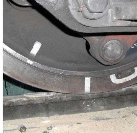
Rys. 16. Nieprawidłowe ustawienie białych linii na kole bosym i obręczy koła
