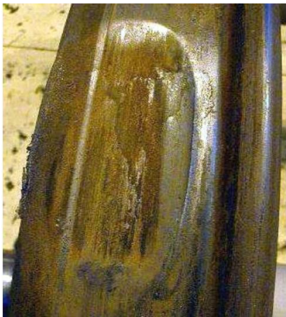
8 e Wady spłaszczenia okręgu tocznego koła
