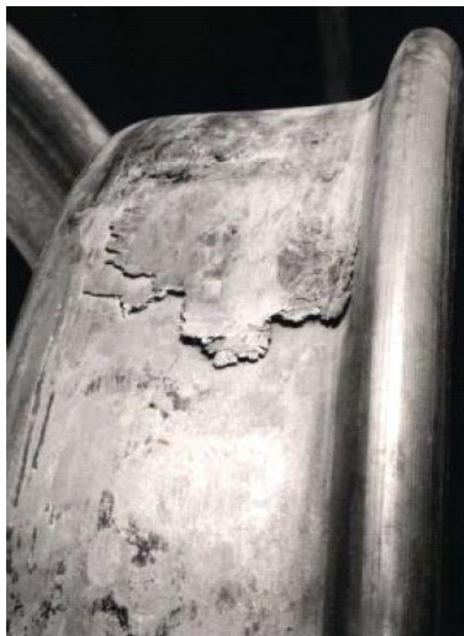
8 d Widok nawarstwienia metalu na powierzchni tocznej koła - nalepy
