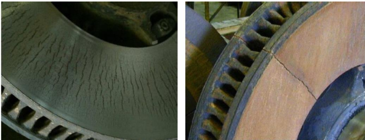
Rys. 15. Wady tarcz hamulca
